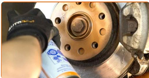
**30** Vyčistěte povrch brzdového kotouče. Použijte čistič brzd.
