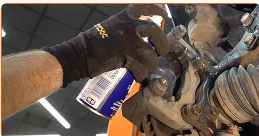
**13** Odšroubujte upevnění svorky brzdového třmenu. Použijte nástavec č.17. Použijte ráčnový klíč.
