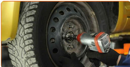
Výměna: brzdového kotouče - TOYOTA Yaris Verso (\_P2\_). Tip:
