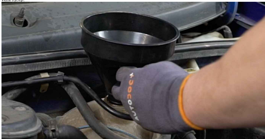
35 Chladicí kapalinu nalijte do nádrčky na chladicí kapalinu.
