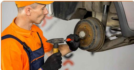
Výměna: brzdové čelisti - VAUXHALL Astra Mk III (F) Combi (T92). Tip:
