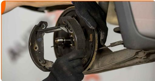
Výměna: brzdové čelisti - VAUXHALL Astra Mk III (F) Combi (T92). Doporučují odborníci z AUTODOC:
