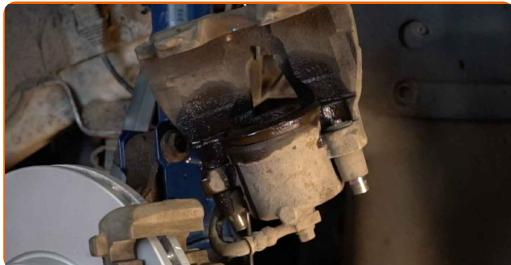
Výměna: brzdového kotouče - VAUXHALL Astra Mk IV (G) Cabrio (T98). Tip:
