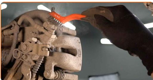
**8** Vyčistěte místo, kde se brzdová hadička spojuje se třmenem, a místo vodících závlaček. Použijte drátěný kartáč. Použijte čistič brzd.
