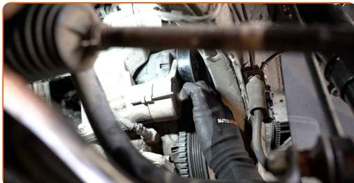
Výměna: drážkového řemene - VAUXHALL Astra Mk IV (G) Cabrio (T98). Tip:
