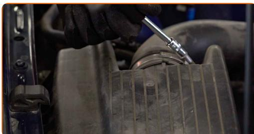
4 Odpojte trubku na přívod vzduchu od krytu vzduchového filtru.
