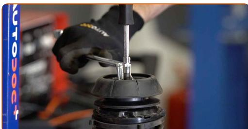
Výměna: pružiny podvozku - VAUXHALL Astra Mk IV (G) CC (T98).
