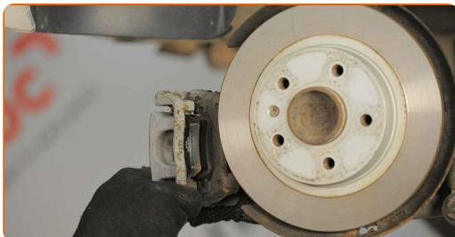
Výměna: brzdového kotouče - VAUXHALL Astra Mk V (H) Combi (A04).
