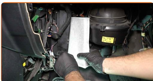
Výměna: kabinového filtru - VAUXHALL Astra Mk VI (J) Combi (P10).
