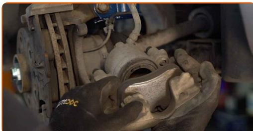
Výměna: brzdové destičky - VAUXHALL Astra Mk VI (J) (P10) Hatchback. Tip od AUTODOC:
