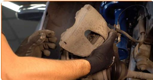
Výměna: brzdové destičky - VAUXHALL Astra Mk VI (J) (P10) Hatchback.
