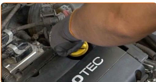
**4** Vyčistěte uzávěr krytu olejového filtru. Použijte víceúčelový čistící sprej.
