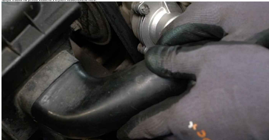
32 Připevněte sponu na sací hadici vzduchového filtru.
