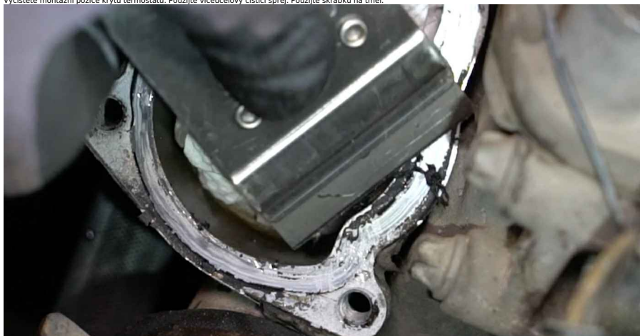
25 Nainstalujte nový kryt termostatu spolu s termostatem.
