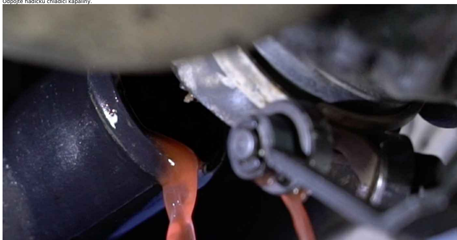
8 Odpojte hadičku chladič kapaliny.
