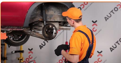
**16** Nainstalujte nový brzdový válec.
