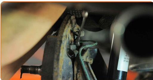
Výměna: brzdového válečku - VAUXHALL Astra Mk3 (F) Cabrio (T92).
