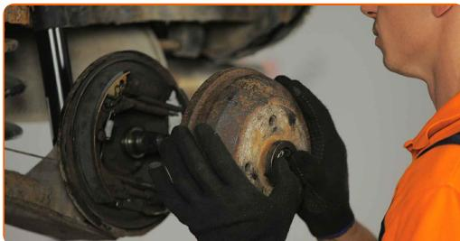
Výměna: brzdového válečku - VAUXHALL Astravan Mk III (F) (T92).
