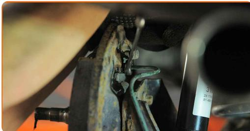
Výměna: brzdového válečku - VAUXHALL Astravan Mk III (F) (T92). AUTODOC doporučuje:
