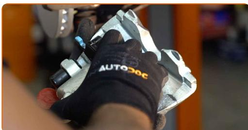
Výměna: brzdového třmenu - VAUXHALL Astravan Mk IV (G) (T98).
