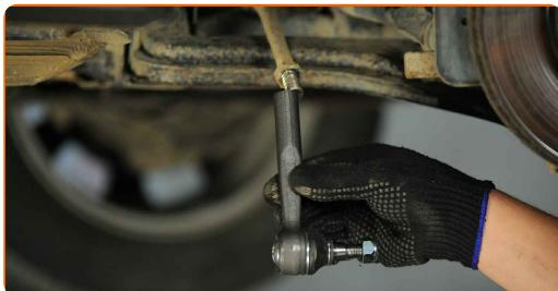
**Výměna: kulového čepu řízení - VAUXHALL Astravan Mk IV (G) (T98).**
