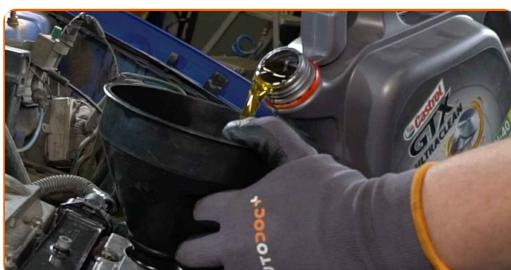
Výměna: motorového oleje a filtru - VAUXHALL Carlton Mk III Sedan (V87).
