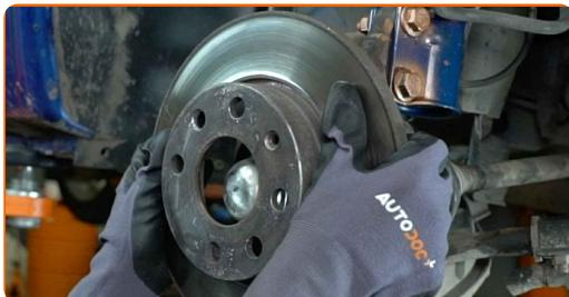
Výměna: brzdového kotouče - VAUXHALL Cavalier Mk2 Combi (J82). Tip od AUTODOC:
