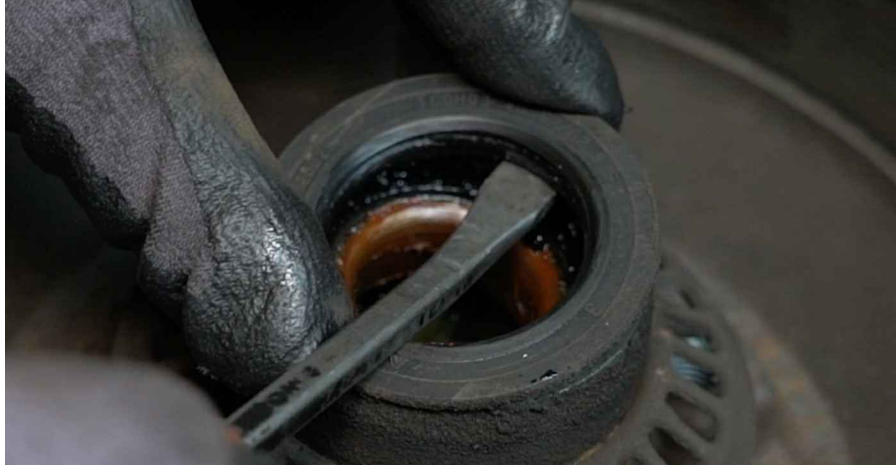
13 Odstraňte ložisko náboje kola. Použijte páčidlo.
