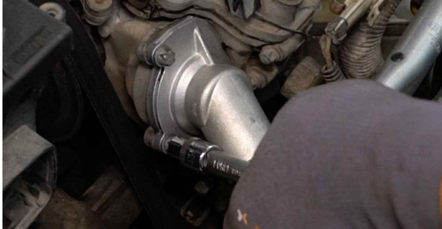
28 Připojte hadičku chladicí kapaliny.
