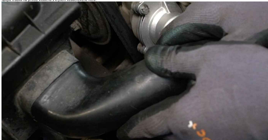
32 Přípevněte sponu na sací hadici vzduchového filtru.
