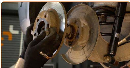
Výměna: brzdového kotouče - VAUXHALL COMBO TOUR Mk II (C) (F25). Tip:
