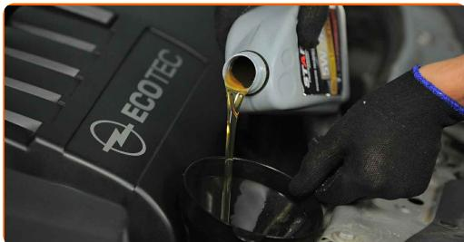
Výměna: motorového oleje a filtru - VAUXHALL Corsa Mk II (C) Hatchback (X01). Tip od odborníků z AUTODOC:
