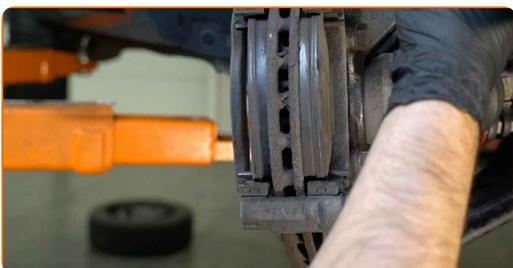
Výměna: brzdového kotouče - VAUXHALL Corsa Mk IV (E) Hatchback (X15).
