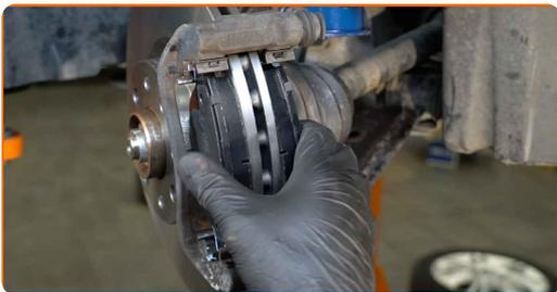
**30** Nainstalujte brzdový třmen a upevněte jej. Použijte nástavec č.13. Použijte momentový klíč. Utáhněte ji točivým momentem 30 Nm.
