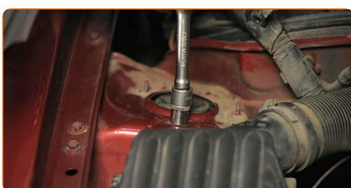
Výměna: pružiny podvozku - VAUXHALL CORSAVAN Mk I (B). AUTODOC doporučuje:
