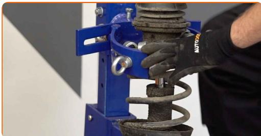
Výměna: pružiny podvozku - VAUXHALL CORSAVAN Mk I (B). Tip od AUTODOC:
