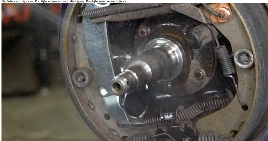
24 Nainstalujte brzdový buben v sestavě s ložiskem náboje.
