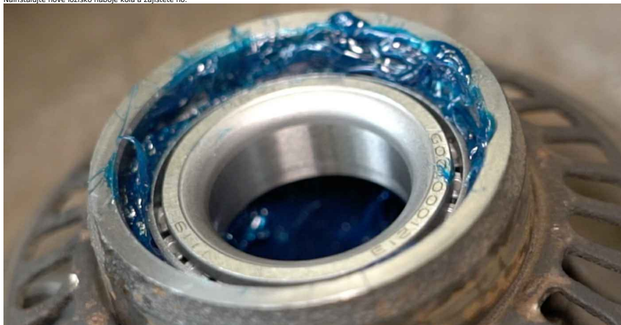
22 Nainstalujte olejové těsnění ložiska kola.
