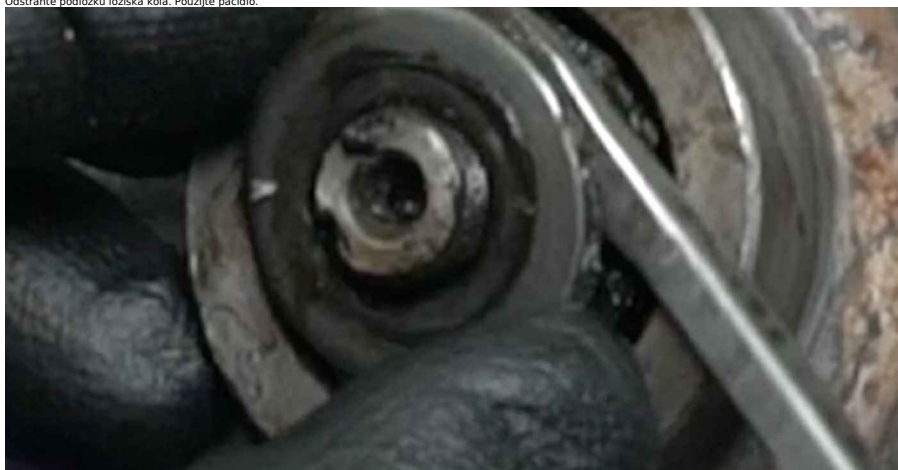
10 Odstraňte ložisko náboje kola. Použijte páčidlo.
