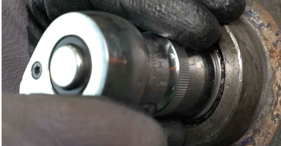
9 Odstraňte podložku ložiska kola. Použijte páčidlo.
