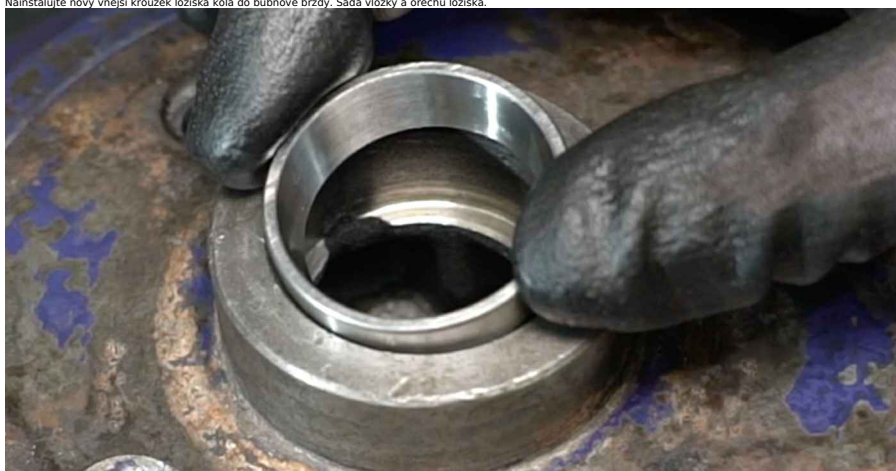
19 Nainstalujte novou vnitřní drážku ložiska kola do brzdového bubnu. Sada vložky a ořechu ložiska.
