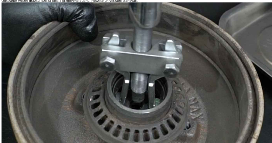
15 Odstraňte vnitřní drážku ložiska kola z brzdového bubnu. Použijte univerzální stahovač.
