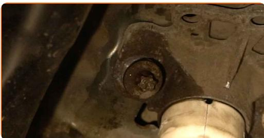
**28** Zašroubujte vrchní upevňovací prvek tlumiče. Použijte nástavec č.E16. Použijte ráčnový klíč.
