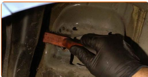
**25** Natřete upevňovací prvek tyče tlumiče. Použijte měděné mazivo.
