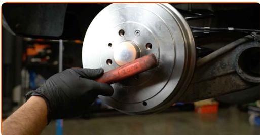
**40** Natřete povrch v místě kontaktu ráfku kola s bubnovou brzdou. Použijte měděné mazivo.
