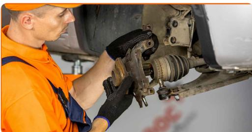
**35** Zapojte kulový čep k čepu řízení.
