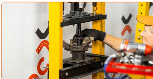
Výměna: ložiska kola - VAUXHALL Meriva Mk I (A) (X03). Doporučují odborníci z AUTODOC:
