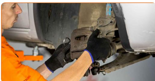
Výměna: ložiska kola - VAUXHALL Meriva Mk I (A) (X03). Tip:
