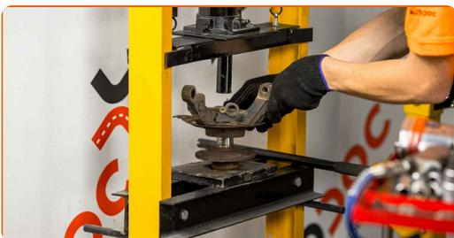
Výměna: ložiska kola - VAUXHALL Meriva Mk I (A) (X03). Tip od odborníků z AUTODOC:
