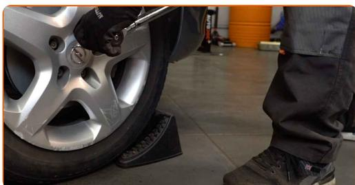
Výměna: kulového čepu řízení - VAUXHALL Meriva Mk II (B) (S10). Tip od odborníků z AUTODOC:
