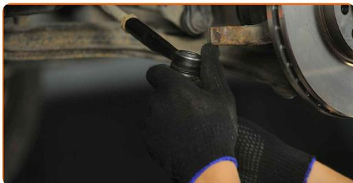
Výměna: kulového čepu řízení - VAUXHALL Meriva Mk II (B) (S10). AUTODOC doporučuje:
