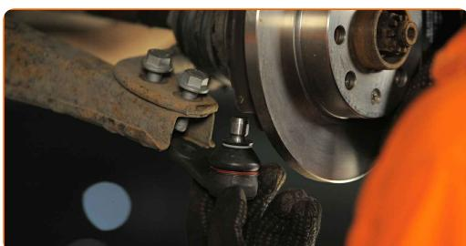
Výměna: kulový čep ramene - VAUXHALL Nova CC (S83). Doporučují odborníci z AUTODOC:
