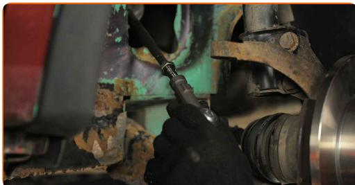
Výměna: kulového čepu řízení - VAUXHALL Nova CC (S83). Profesionálové doporučují:
