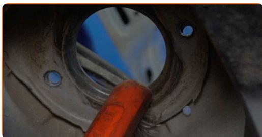
**38** Nainstalujte vzpěru tlumiče do oblouku kola.
