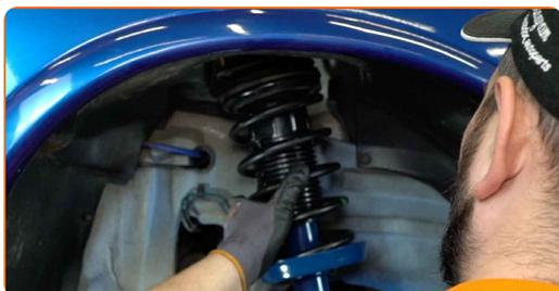
**39** Zajistěte vrchní upevnění vzpěry tlumiče. Neutahujte ho.
