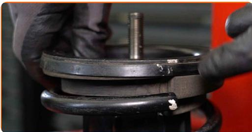
**33** Upevněte matici pístu vzpěry tlumiče. Použijte imbusový klíč č. H5. Použijte nástavec č.19. Použijte momentový klíč. Utáhněte ji točivým momentem 55 Nm.
