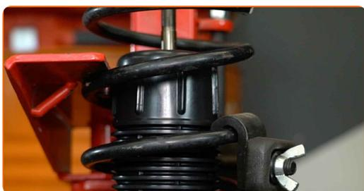
**32** Nainstalujte vrchní držák pružinové vzpěry a ložisko vzpěry.
