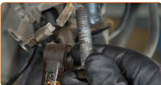
**16** Odpojte kloub řízení od vzpěry tlumiče.
