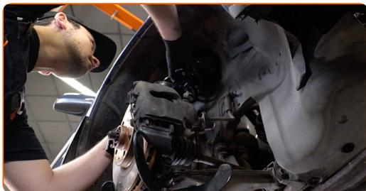
**30** Utáhněte vrchní upeňovací matici vzpěry tlumiče. Neutahujte ho.
