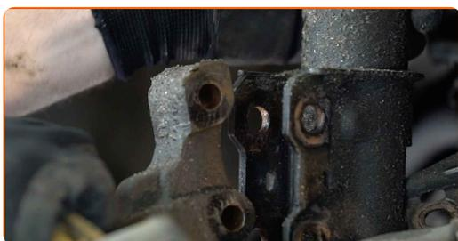
**15** Odšroubujte vrchní upevnění vzpěry tlumiče. Použijte kombinační klíč č.19. Použijte nástavec č.9. Použijte ráčnový klíč.
