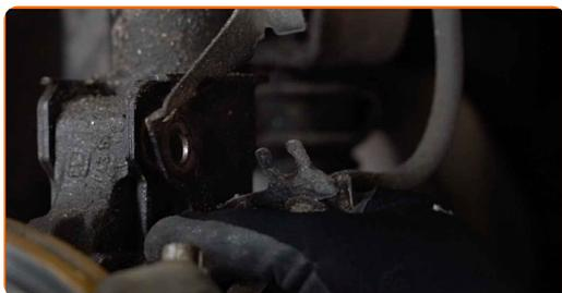
**14** Odpojte kloub řízení od vzpěry tlumiče.
