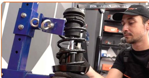
**29** Nainstalujte vzpěru tlumiče do oblouku kola.
