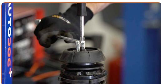
Výměna: pružiny podvozku - VAUXHALL Vectra (B) CC (J96). Profesionálové doporučují:
