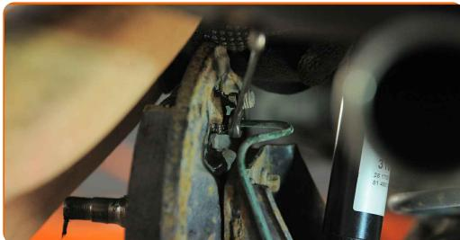
Výměna: brzdového válečku - VAUXHALL Vectra (B) CC (J96). AUTODOC doporučuje:
