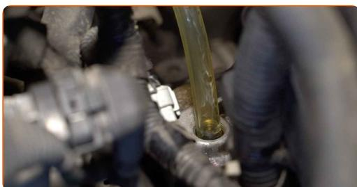
**Výměna: olej do manuální převodovky - VAUXHALL Viva (C16). Tip od odborníků z AUTODOC:**
