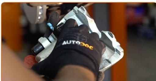
Výměna: brzdového třmenu - VAUXHALL Zafira Mk II (B) (A05). Profesionálové doporučují:
