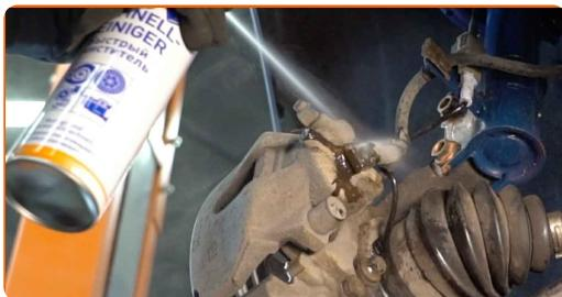
Výměna: brzdového třmenu - VAUXHALL Zafira Mk II (B) (A05). AUTODOC doporučuje:
