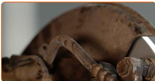
27 Vyčistěte špínu ze šroubu brzdové hadice. Použijte drátěný kartáč. Použijte čistič brzd.
