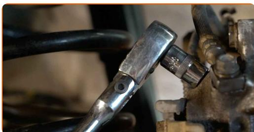
29 Zapojte set na odvzdušnění brzd do šroubu prvku na odvzdušnění brzd.
