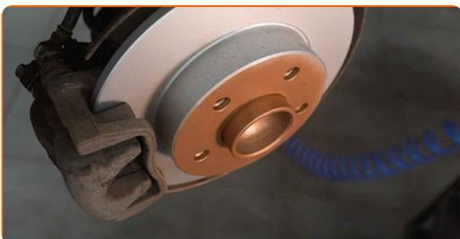
**35** Vyčistěte povrch brzdového kotouče. Použijte čistič brzd.
