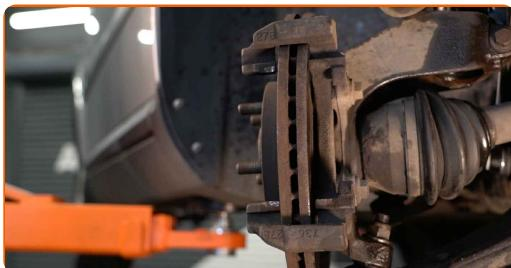
Výměna: brzdové destičky - VOLVO C70 I Kupé (872). Tip:
