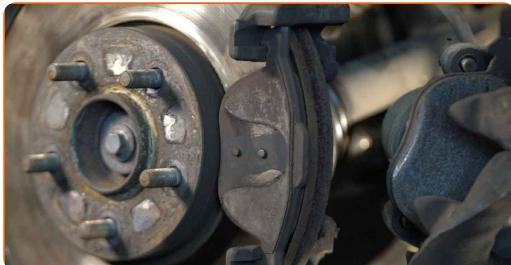
Výměna: brzdové destičky - VOLVO C70 I Kupé (872). Doporučují odborníci z AUTODOC:
