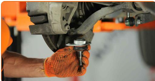
Výměna: kulový čep ramene - VOLVO S60 I (384). Profesionálové doporučují:
