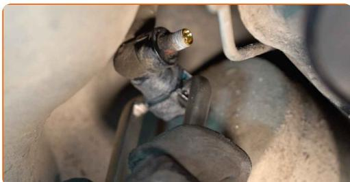
Výměna: palivového filtru - VOLVO S60 I (P24, 384). Profesionálové doporučují:
