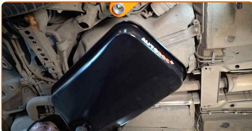
**5** Vyčistěte upevňovací prvky hadiček na dodávku paliva. Použijte drátěný kartáč. Použijte víceúčelový čistící sprej.
