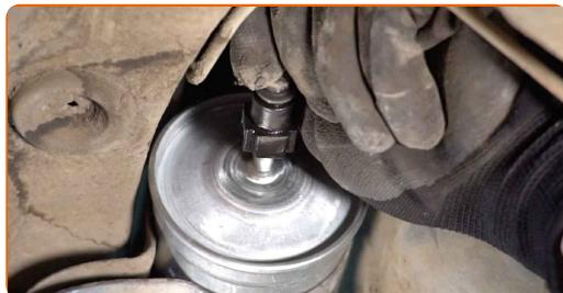
Výměna: palivového filtru - VOLVO S60 I (P24, 384). Doporučují odborníci z AUTODOC:
