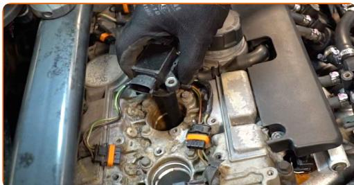
**Výměna: zapalovacích svíček - VOLVO S70 (874). Doporučují odborníci z AUTODOC:**
