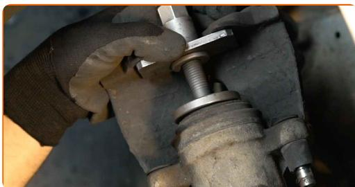
Výměna: brzdové destičky - VOLVO V40 Hatchback (525, 526). Profesionálové doporučují:
