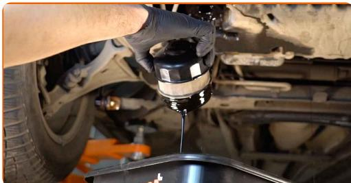
Výměna: motorového oleje a filtru - VOLVO V70 I (LV, 875, 876). Tip od odborníků z AUTODOC:
