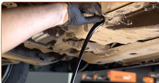
Výměna: motorového oleje a filtru - VOLVO V70 I (LV, 875, 876).
