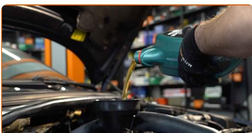
Výměna: motorového oleje a filtru - VOLVO V70 I (LV, 875, 876). Tip od AUTODOC:
