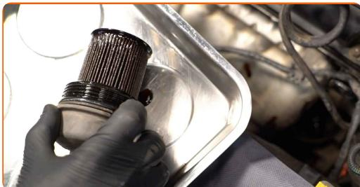
Výměna: motorového oleje a filtru - VOLVO V70 III (BW, 135). Tip od odborníků z AUTODOC:
