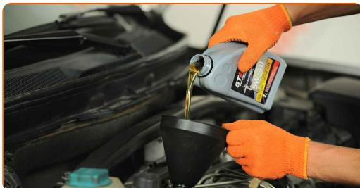
Výměna: motorového oleje a filtru - VOLVO V70 III (BW, 135). Doporučují odborníci z AUTODOC:
