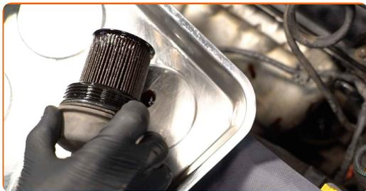
Výměna: motorového oleje a filtru - VOLVO V70 III Van / Combi (135). Tip od odborníků z AUTODOC:
