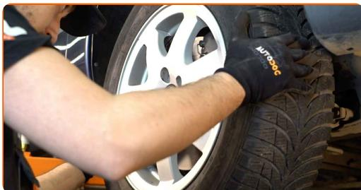
Výměna: brzdového kotouče - VOLVO XC70 Cross Country (295).
