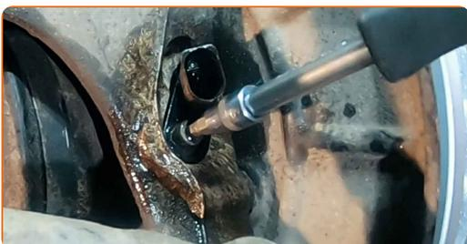
**9** Odpojte snímač ABS.
