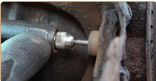
**19** Natřete upevňovací prvek ABS senzoru. Použijte víceúčelové mazivo.
