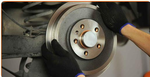
**25** Utáhněte upevňovací prvky brzdového bubnu. Použijte hvězdicový Torx T 30. Použijte momentový klíč. Utáhněte ji točivým momentem 4 Nm.
