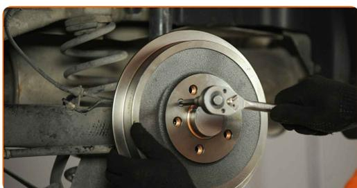
**26** Vyčistěte montážní otvor disku kola. Použijte drátěný kartáč.
