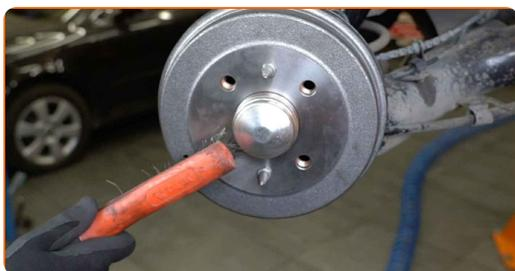
**27** Natřete povrch v místě kontaktu ráfku kola s bubnovou brzdou. Použijte vysokoteplotní keramické mazivo.
