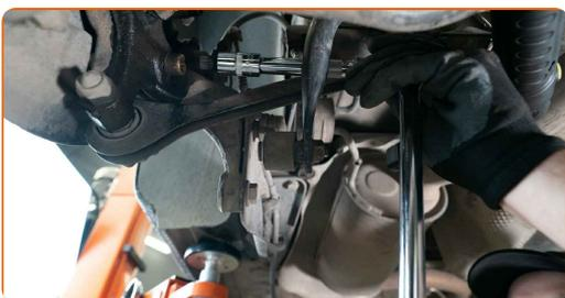
**11** Odstraňte brzdový třmen spolu s jeho držákem.
