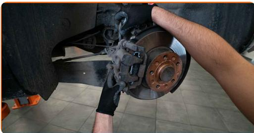
**19** Upevněte svorku brzdového třmenu. Použijte XZN č. 14. Použijte momentový klíč. Utáhněte ji točivým momentem 90 Nm.
