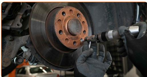
Výměna: brzdového kotouče - VW CADDY CALIFORNIA V Camper (SBB, SBJ).
